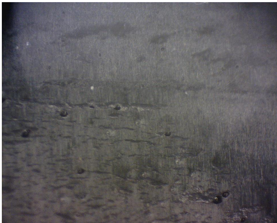
Imagem 9: Molde tirado no aerogerador nº 41 depois do tratamento.
